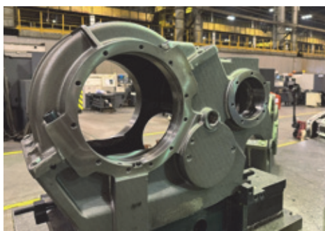
Рис. 3. Скоростной тяговый редуктор разработки компании «Уральские локомотивы»
