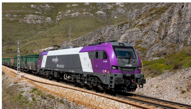
Рис. 7. Многосистемный шестиосный электровоз Euro6000
