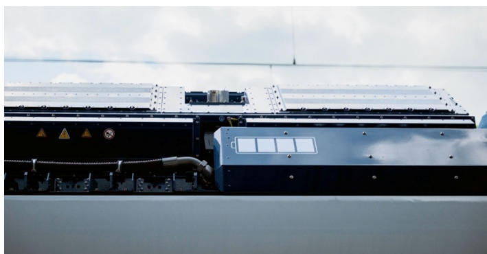
Рис. 7. Литий-титанатные тяговые аккумуляторы
