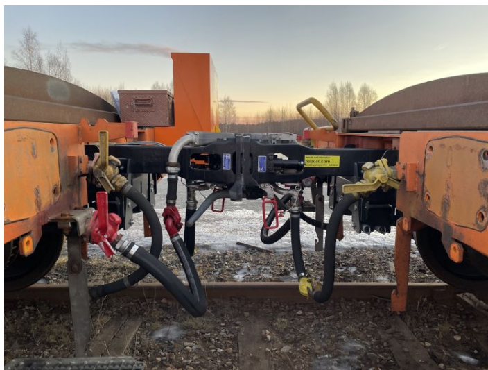
Рис. 9. испытания цифровых автоматических сцепок (DAC)
