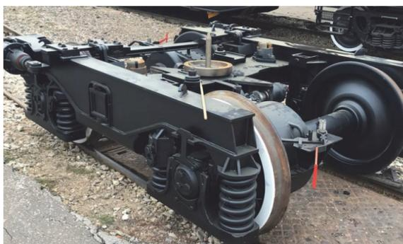
Рис. 1. Тележка новой конструкции для путевых машин от «Тулажелдормаш»
