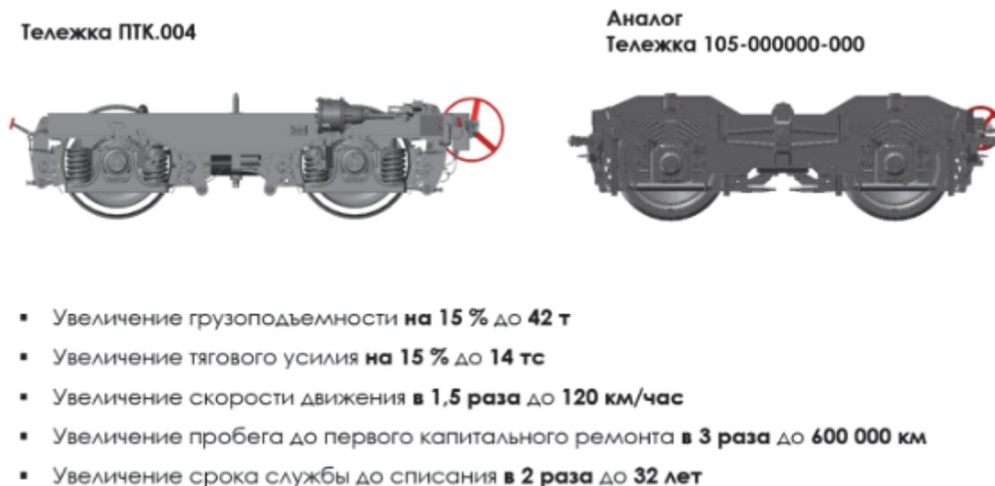
Рис. 3. Показатели тележки ПТК.004 относительно тележки 105-000000-000
