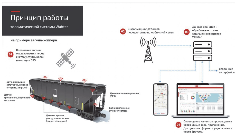
Рис. 9. Принцип работы телематической системы Wabtec
