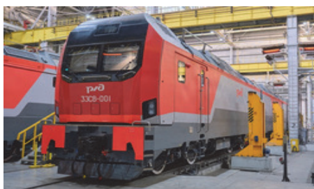
Рис. 8. Первый грузовой магистральный электровоз ЭЭС8 «Малахит»
