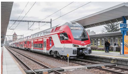
Рис. 5. Двухэтажный электропоезд семейства KISS
