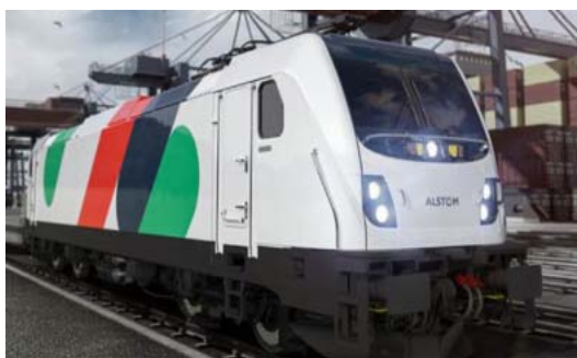
Рис. 5. Многосистемный электровоз Traxx Universal
