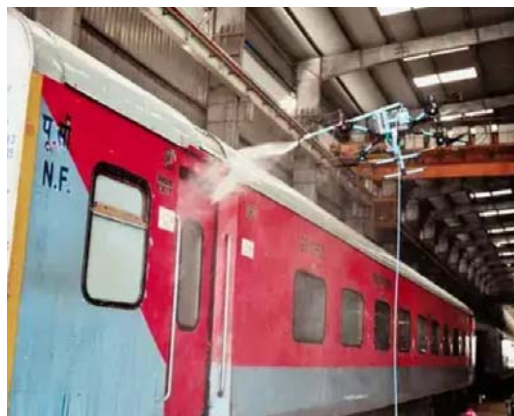
Рис. 4. Уборка подвижного состава с помощью дрона
