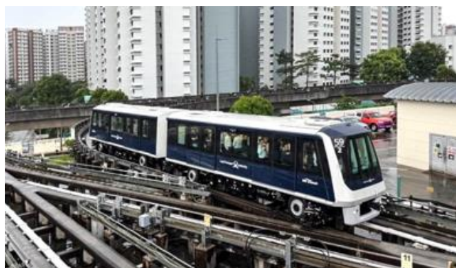
Рис. 5. Поезд на шинном ходу, поставленный в Сингапур
