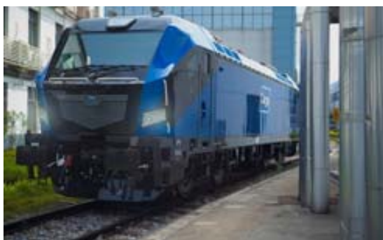
Рис. 7. В Венгрии испытали аккумуляторный режим магистрального электровоза CRRC
