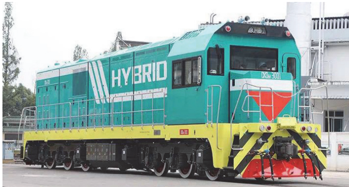
Рис. 8. Гибридный маневровый локомотив CKD6H
