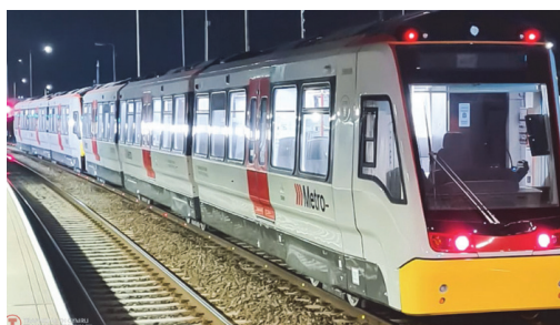
Рис. 1. Испытания гибридного трамвайного поезда Stadler CITYLINK
