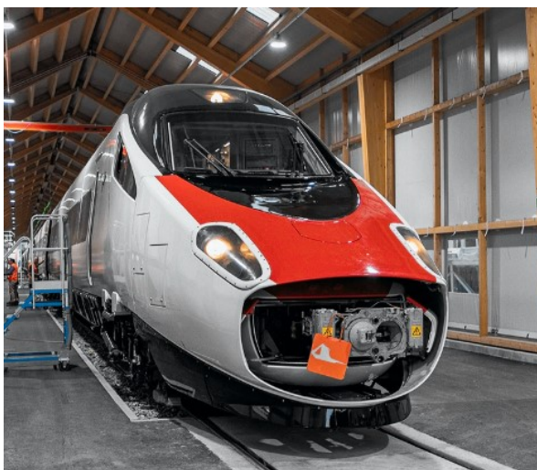
Рис. 2. Электропоезд Astoro с наклоном кузова
