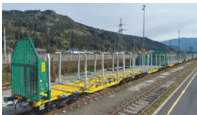
Рис. 6. Вагон Sgwrs для транспортировки круглого леса и пиломатериалов
