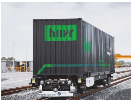
Рис. 4. Беспилотный рельсовый экипаж Hiiv Rail с тяговыми аккумуляторами
