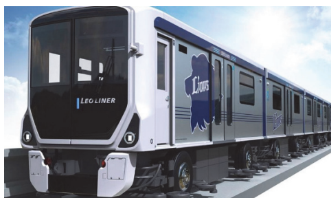
Рис. 7. Поезд на шинном ходу для автоматизированной линии Seibu Yamaguchi
