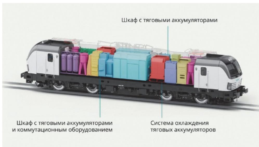
*Рис. 9. Электровоз Vectron с тяговыми аккумуляторами*
