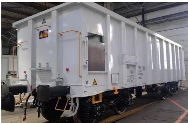
Рис. 7. Полувагон модели Eamnos «Light Version» типа E06B
