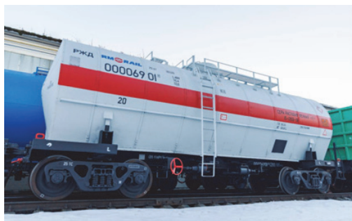
Рис. 1. Цистерна 15-1269-01 для расплавленной серы
