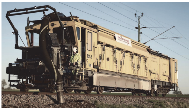
Рис. 5. Вакуумная установка Railcare
