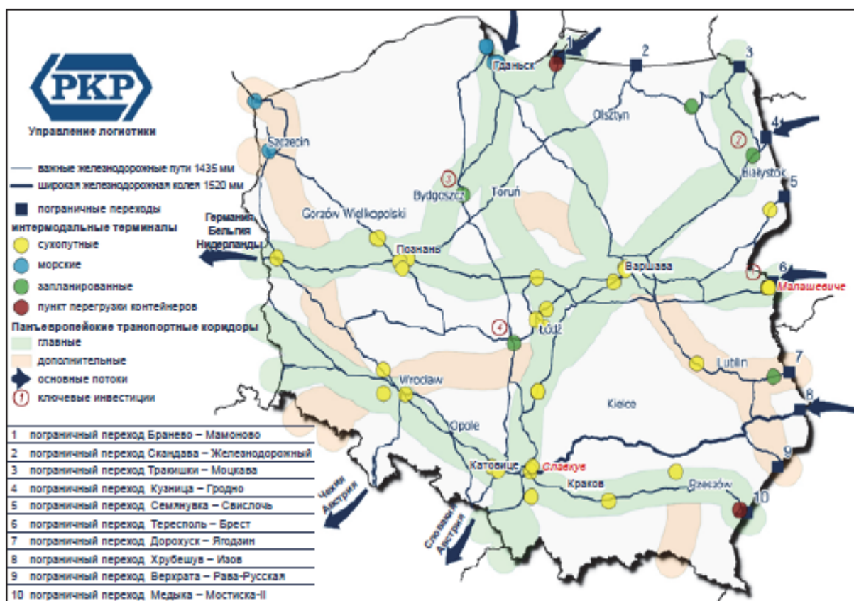
Рис.2. Польские железнодорожные маршруты, имеющие большое значение с точки зрения международных грузовых перевозок и существующих или планируемых интермодальных терминалов
