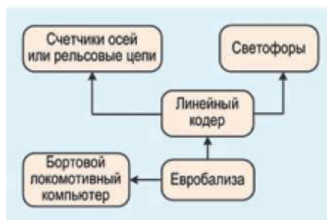
Рис. 11. Схема, поясняющая принцип организации ИРДП ERTMS посредством напольного оборудования
