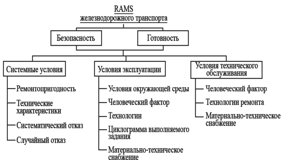
Рис. 2. Факторы, влияющие на RAMS (упрощенная схема на основе EN 50126)
