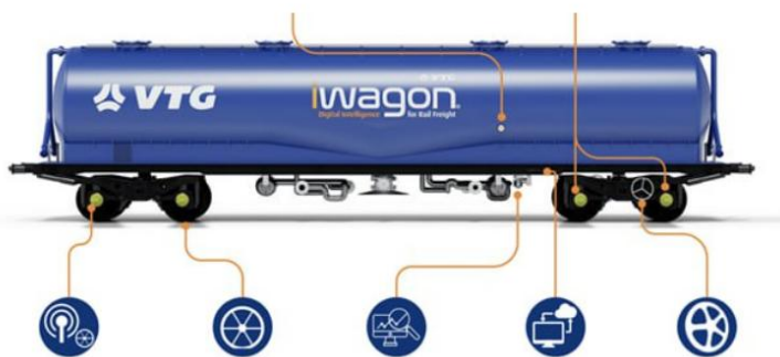
Рис. 2. Схема новой системы мониторинга грузовых вагонов в режиме реального времени iWagon
