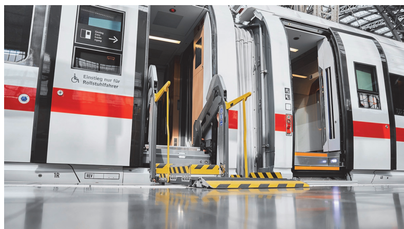
Рис. 1. Подъемник новой конструкции, облегчающий доступ в вагон пассажиров на инвалидных колясках
