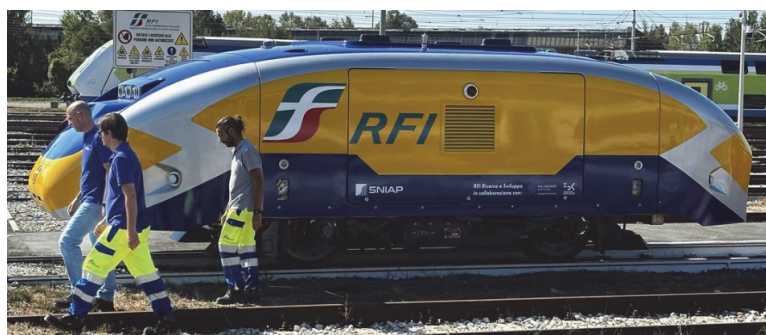
Рис. 3. Прототип URV для автоматизированного контроля высокоскоростных линий
