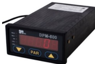
Рис. 4. Цифровой манометр DPM-500
