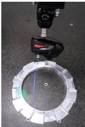
*Рис. 2. Применение лазерного сканера Zephyr III 300*
