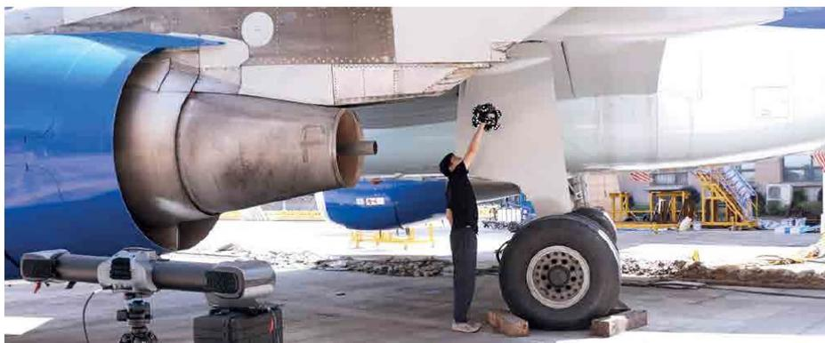
*Рис. 5. Сканирование самолета с помощью TrackScan Sharp S*
