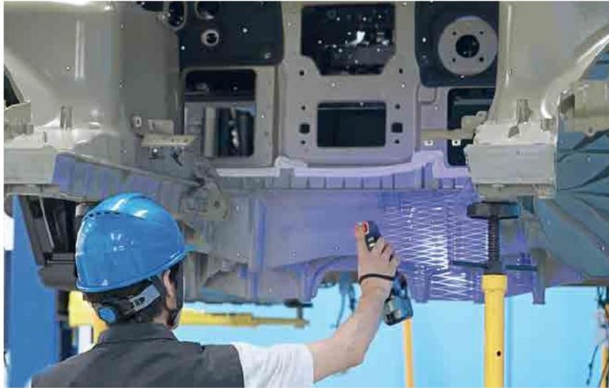
*Рис. 6. Сканирование автомобильного кузова с помощью SIMSCAN E*
