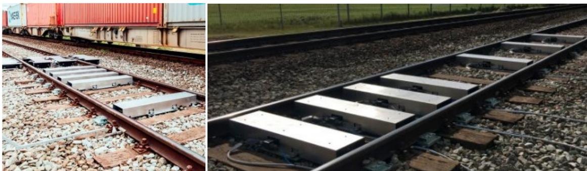
*Рис. 3. Система измерения рыскания поезда*
