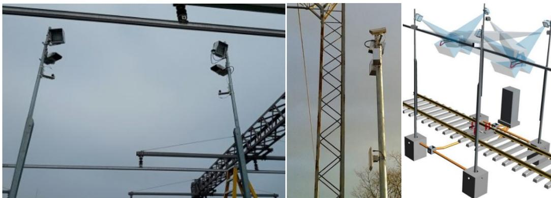
*Рис. 4. Система измерения подъема провода контактной сети*
