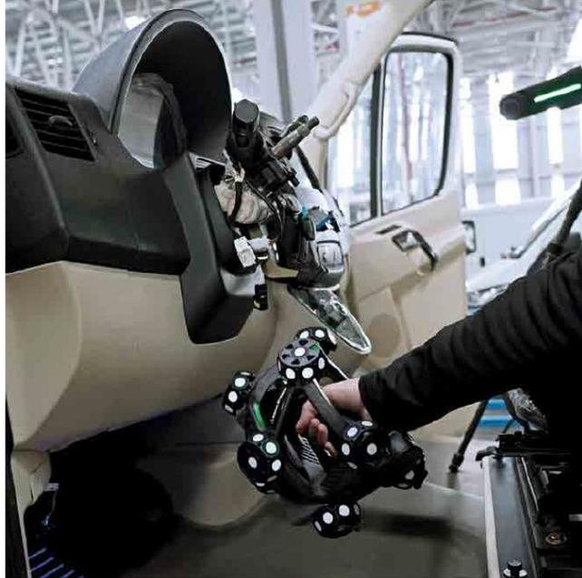
*Рис. 4. Сканирование интерьера автомобиля с помощью AM.TECH NimbleTrack C*
