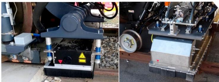
Рис. 1. Система измерения рельсового профиля (RPMS)
