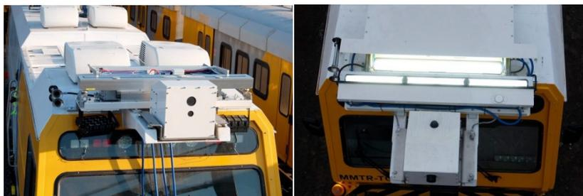
Рис. 2. Система измерения износа проводов (WWMS)
