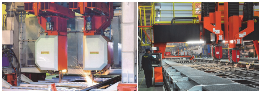
Рис. 2. Робототехнические комплексы по обслуживанию прессов и плазменной резки швеллеров и листов
