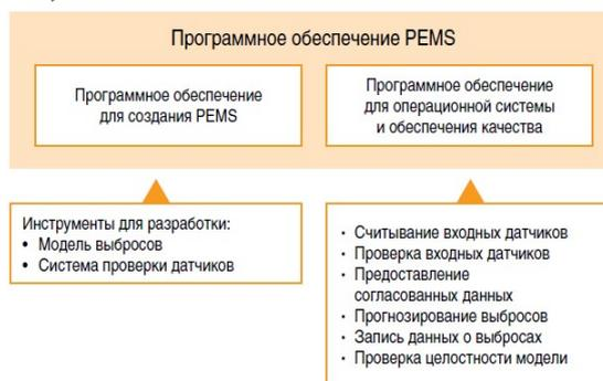
*Рис. 1. Компоненты программного обеспечения ПСКВ
