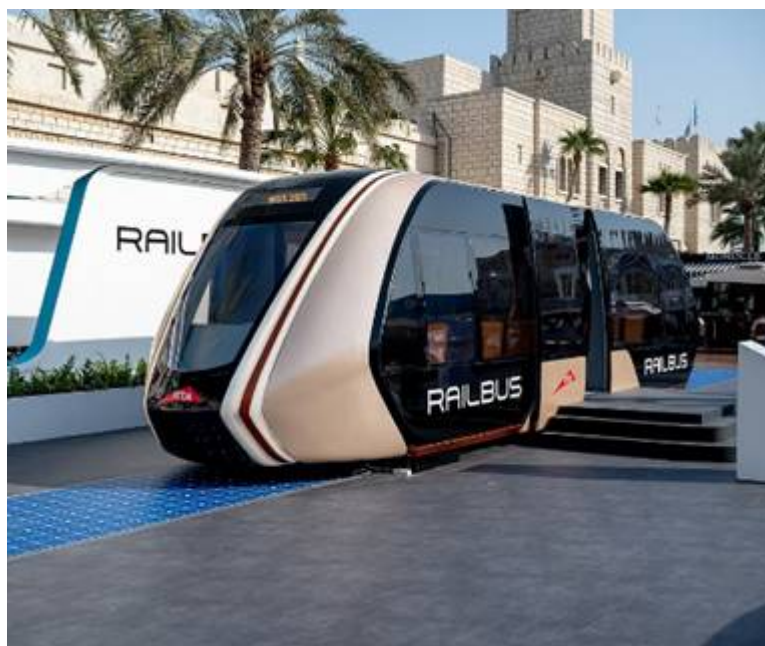
Рис. 1. Прототип рельсового автобуса из переработанных материалов
