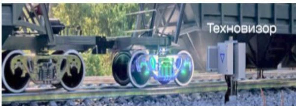
Система автоматизированного визуального контроля технических характеристик подвижного состава «Техновизор» разработки АО «НИИАС»
