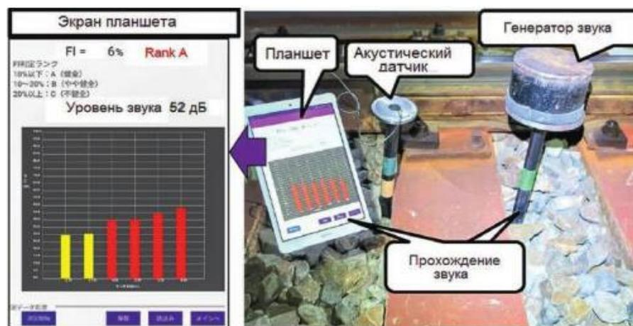
Измерения с помощью системы контроля балласта
