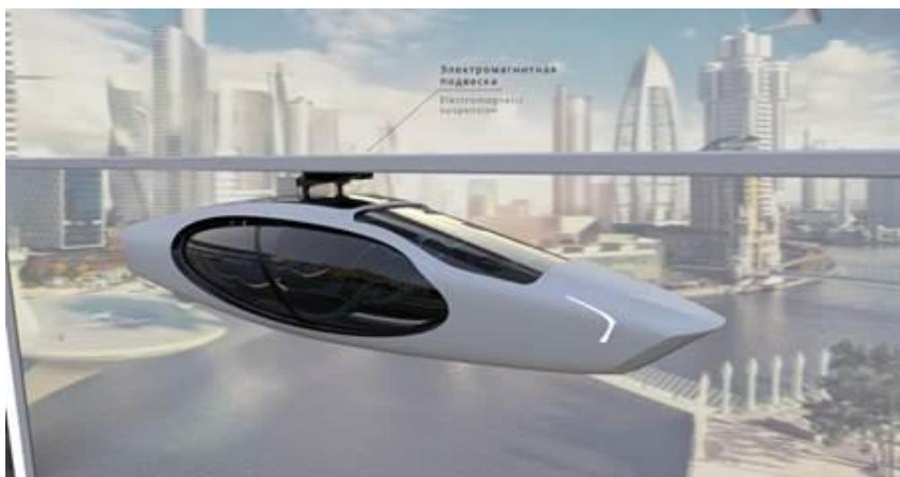
В подвесе капсулы также предусмотрена система активного гидропневматического наклона, которая позволяет корпусу отклоняться на небольшой угол во время поворотов. Это снижает боковые перегрузки и позволяет пассажирам комфортно переносить маневры
