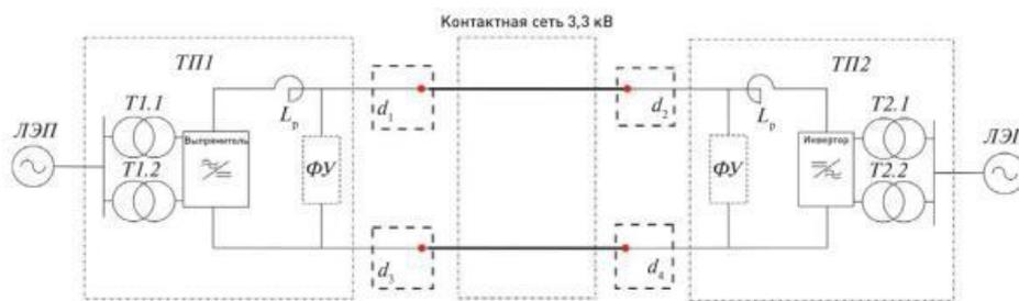
Схема контактной сети с расстановкой приборов контроля системы «пилот-сигнал»: ЛЭП – линия электропередачи; ТП1, ТП2 – тяговые подстанции; Т1.1, Т1.2, Т2.1, Т2.2 – понижающие трансформаторы;  $L_p$  – реактор; ФУ – фильтрующее устройство;  $d_1$  –  $d_4$  – приборы контроля.
