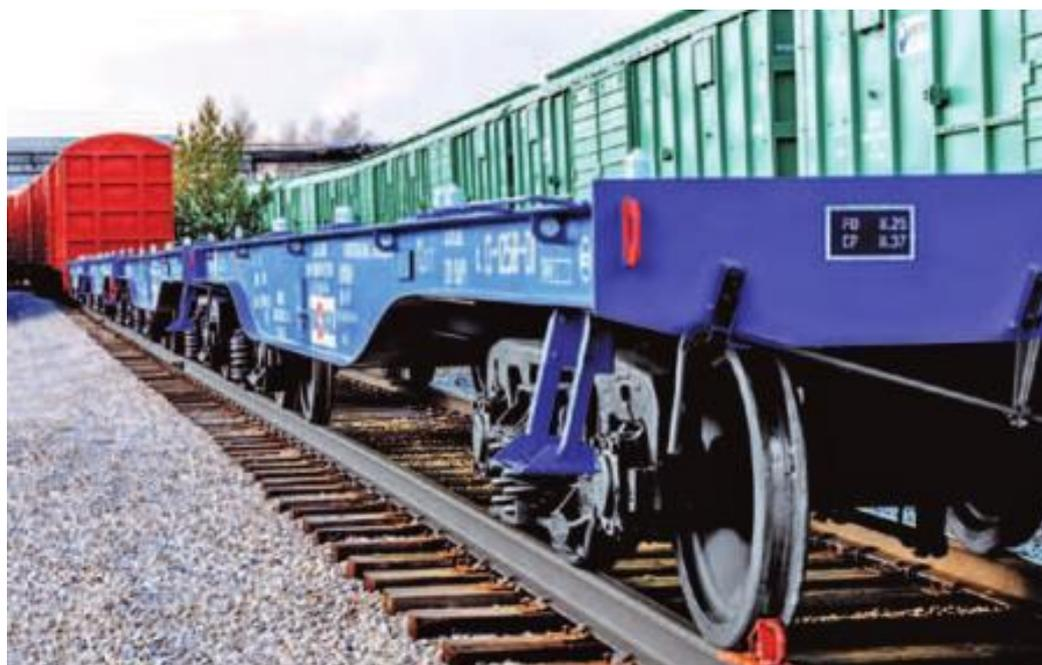
РМ Рейл продолжает работу и над освоением производства нового подвижного состава. Так, в этом году компания сертифицировала вагон-платформу для перевозки леса, труб и контейнеров модели 13-1289 на соответствие требованиям Технического регламента Таможенного союза «О безопасности железнодорожного подвижного состава» (ТР ТС 001/2011).
