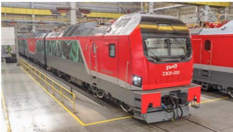
Грузовой электровоз постоянного тока с асинхронным тяговым приводом ЗЭС8-001
