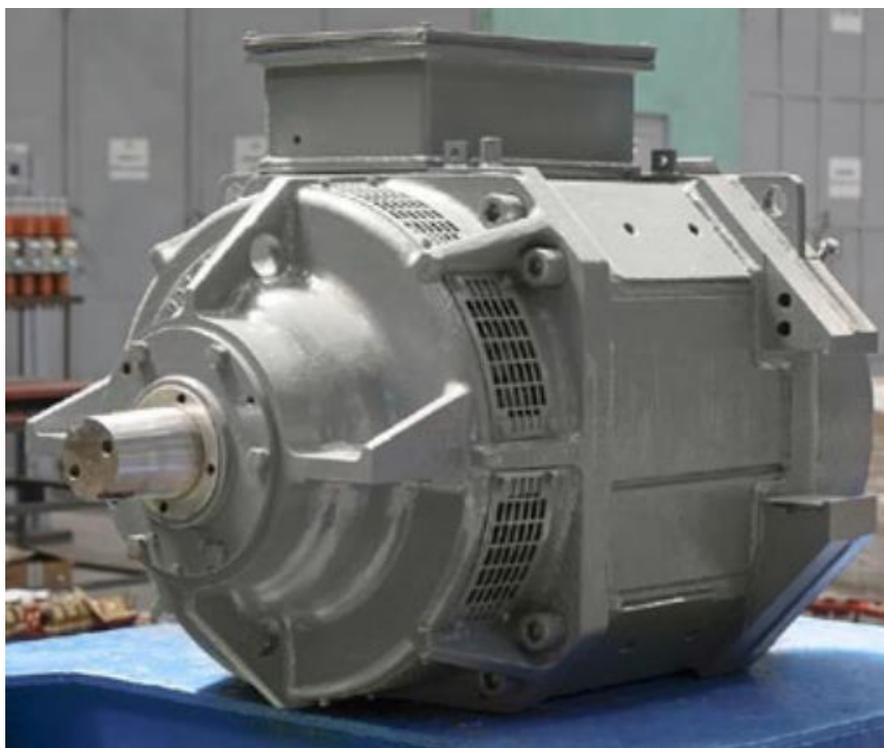
Новый асинхронный двигатель - отечественная разработка, создан в компании «ТМХ Инжиниринг». Технические характеристики тягового двигателя позволяют использовать его в поездах с конструкционной скоростью до 160 км/ч, снизить энергопотребление поезда, значительно увеличить межсервисные интервалы, сократить время обслуживания подвижного состава.
