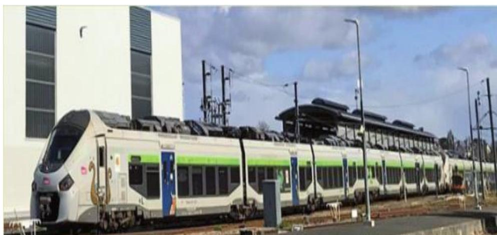
Дизель-поезд, работающий на биотопливе.
