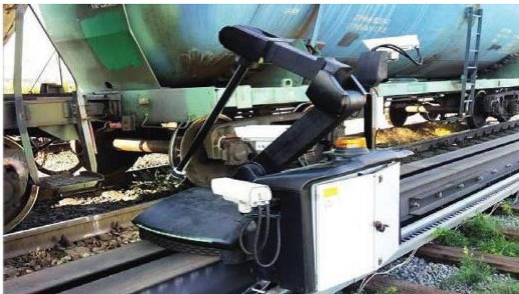
В рамках испытаний осуществлялось воздействие манипулятора РТК с соответствующими технологическими элементами грузового вагона. Главная задача испытаний заключается в проверке правильности функционирования системы управления, а также подсистемы технического зрения. В ходе испытаний произведен повторяемый эксперимент по синхронизации мобильной платформы с автосцепками надвигаемых вагонов и последующей их расцепке в движении в автоматическом режиме.
