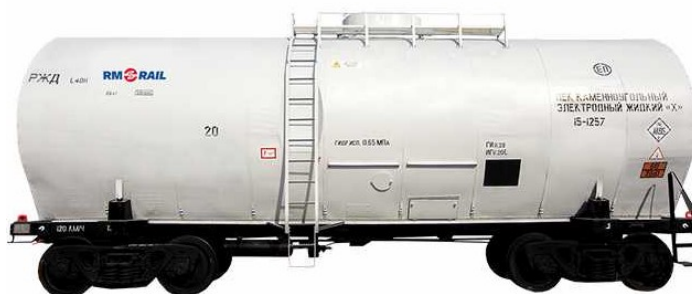
Рис. 1. Вагон-цистерна для перевозки жидкого каменноугольного электродного пека модели 15-1257
