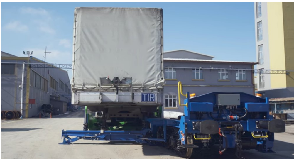
Рис. 2. Полуприцеп установлен на поворотную платформу, тягач отцеплен
