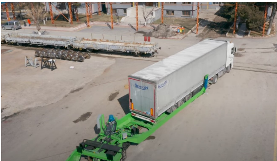
Рис. 1. Полуприцеп надвигается тягачом на поворотную платформу Helrom Trailer Rail
