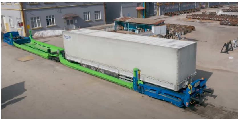
Рис. 3. Полуприцеп установлен в транспортное положение на платформе вагона
