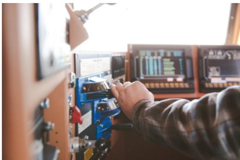
*Рис. 1. Управление системой Trip Optimizer*
