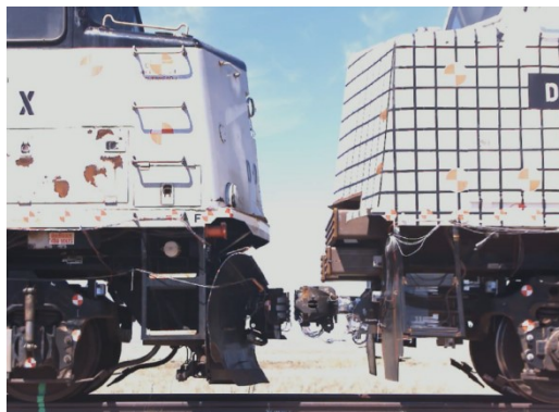
Рис. 2. Локомотивы EMD F40PH со специальными защитными устройствами (справа) и без
