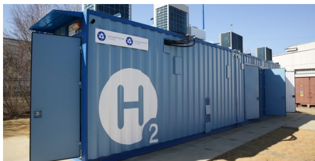
Рис. 1. Инновационная электролизная установка по производству водорода в контейнерном исполнении
