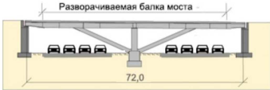
Рис. 3. Примерная схема зонтичного моста через автомагістраль
