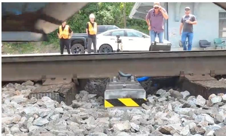
Рис. 1. Энергогенерирующая шпала
