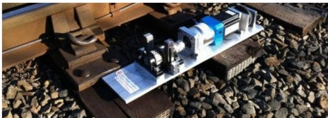
*Рис. 2. Преобразовывать колебания железнодорожных рельсов в электрическую энергию*
