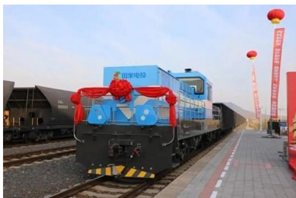
Рис.2 Водородно-аккумуляторный маневровый локомотив
