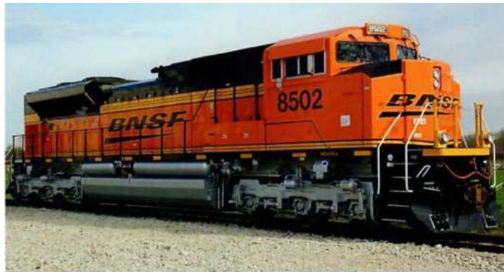
Рис. 2. Магистральный шестиосный тепловоз SD70ACe-P4 постройки компании Progress Rail
