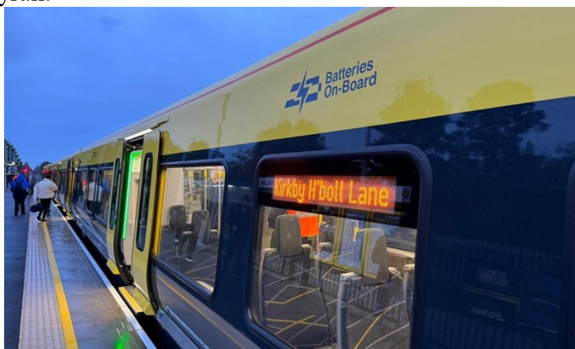
Рис. 1. Новый контактно-аккумуляторный электропоезд Stadler IPEMU на станции
