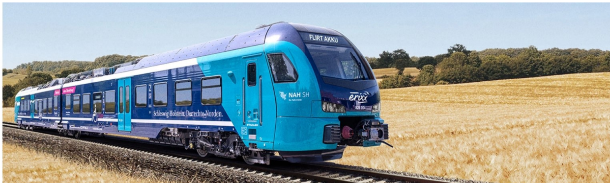
Рис. 2. Контактно-аккумуляторный электропоезд Stadler FLIRT Akku
