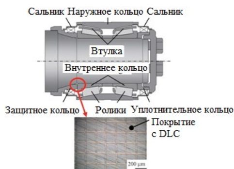
Рис. 3. Закрепленное положение алмазоподобной углеродной пленки (DLC) в осевом подшипнике
