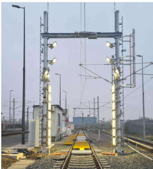
Рис. 1. Диагностический портал E-Check, установленный при въезде на территорию депо
