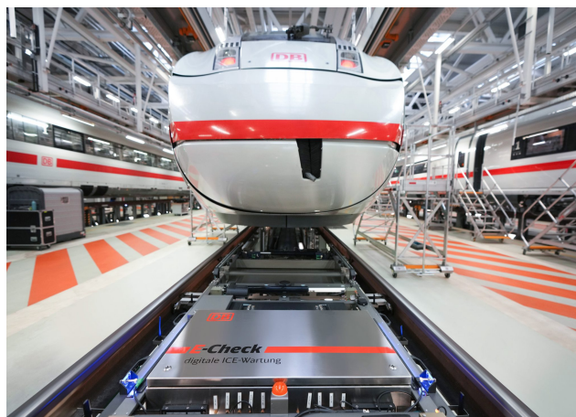
Рис. 1. Диагностический портал E-Check, установленный при въезде на территорию депо
