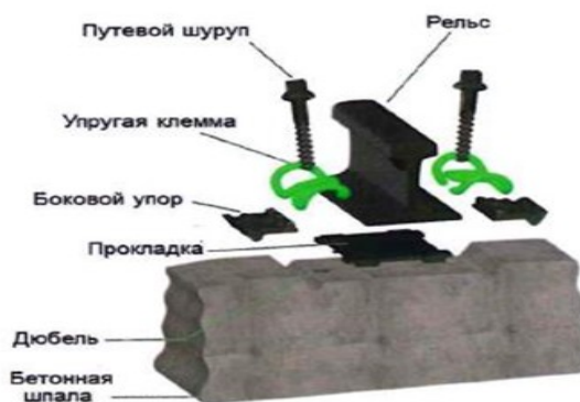
Рис. 1. Рельсовые крепления W30
