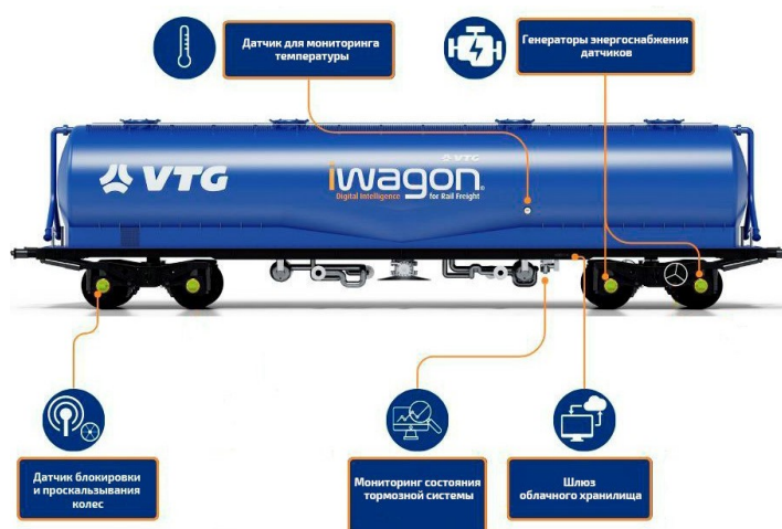
Рис. 1. Схема расположения датчиков iWagon на цистерне
