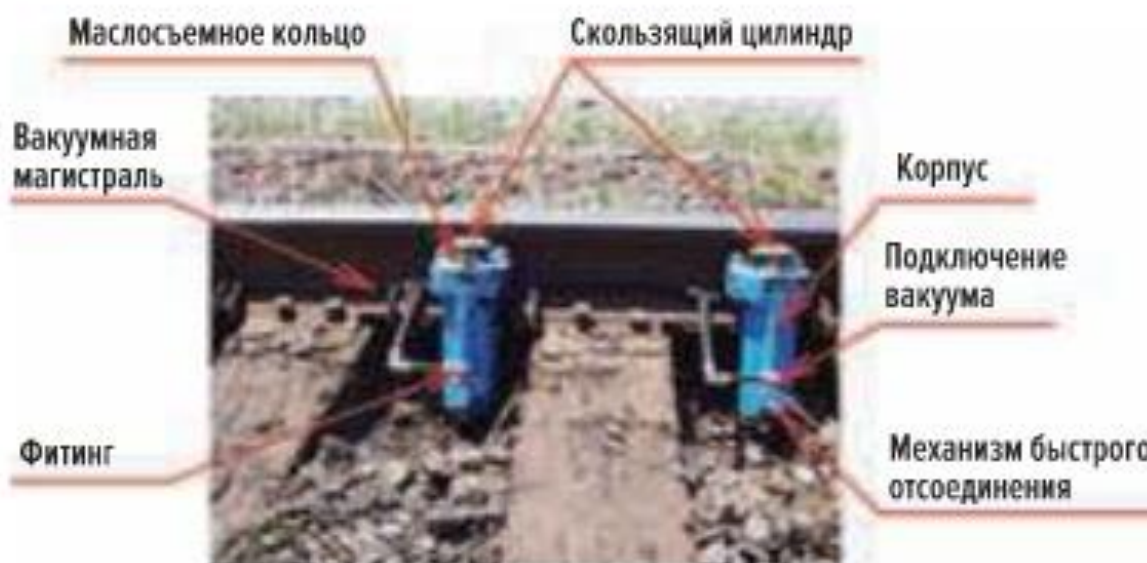
Домкратовидное устройство закрепления подвижного состава
