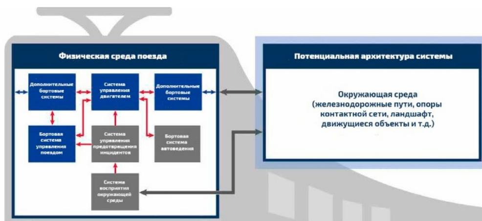
Рис. 1. Замкнутый контур взаимодействия подсистем поезда с окружающей средой в среде моделирования dSPACE
