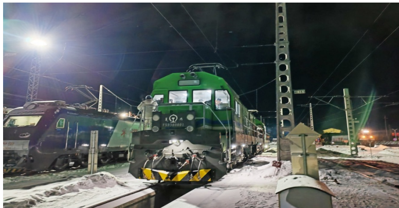
Рис.1 Контактно-аккумуляторный локомотив серии FXD3H от CRRC во время испытаний в Хулун-Буире
