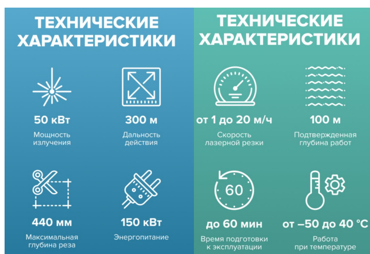
Рис. 2. Технические характеристики мобильного лазерного комплекса
