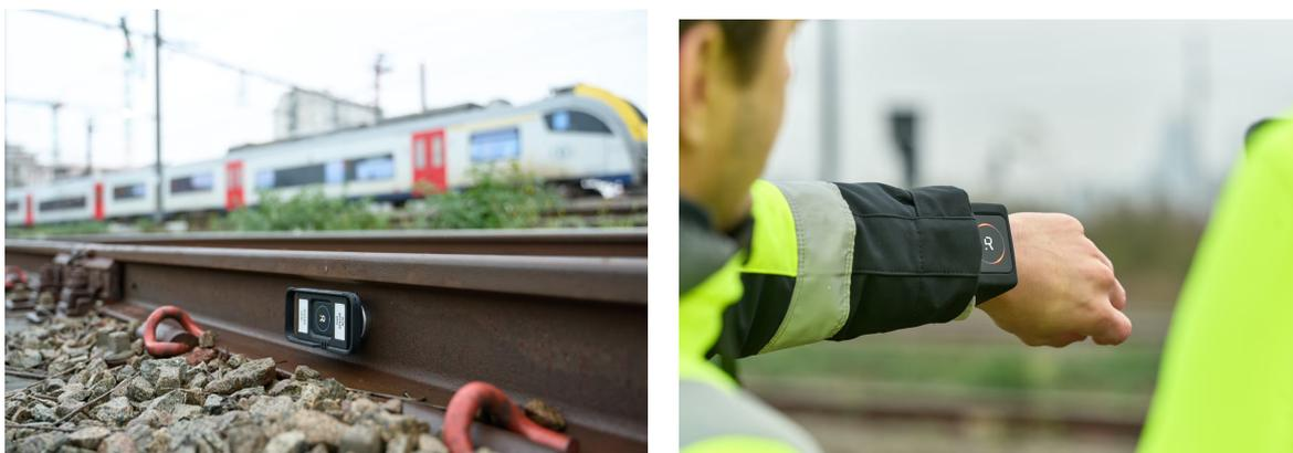
*Рис. 1. Датчик Rombit Infracert, установленный на рельсах, и носимое устройство Infracert*
